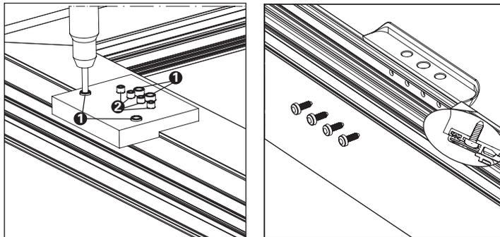
**Posizionare la dima di foratura all'altezza desiderata. Forare in corrispondenza delle bussole 1 con punta Ø 7,2 mm e in corrispondenza delle boccole 2 con punta Ø 4,0 mm. Montare la tasca con le apposite viti M 3,9 mm.**
