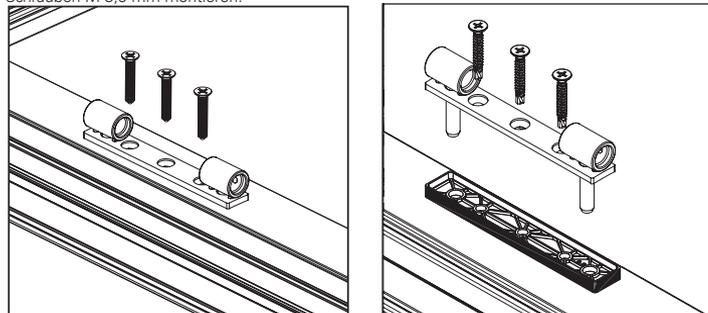
**Montare la piastrina con gli anelli laterali sul telaio, con lo spessore se necessario, con le apposite viti M3,9 mm. IMPORTANTE: orientare i fori laterali degli anelli verso la tasca!**
