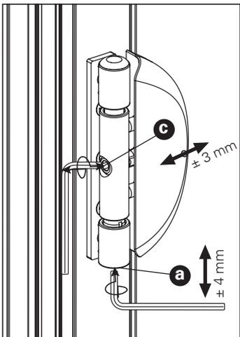
**Regolazione laterale: Agire sulla vite c con chiave a brugola da 5 mm.**
